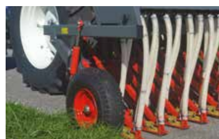
Hydraulische Anpassung der Tiefenräder
