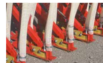
Einfaches Einstellen und Austauschen der Messer
